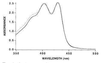
Figure 1 Absorbance spectra of 30/70 PBO/AN film: ----, dried; -----, annealed
